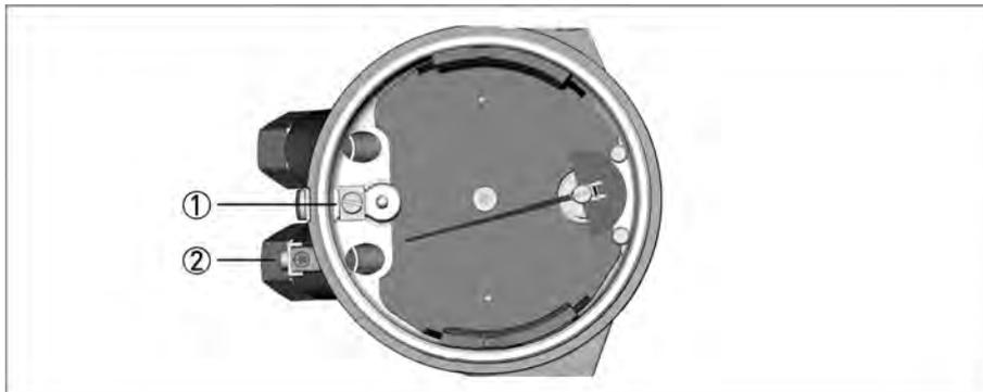
Рисунок 4-15: Подключение заземления
